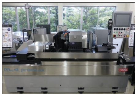
Brusky Toyoda jsou velmi precizně zpracovány a používají pro svoji konstrukci výrazné konstrukční prvky, jakými bezesporu jsou nerezové části ochranných krytů.
