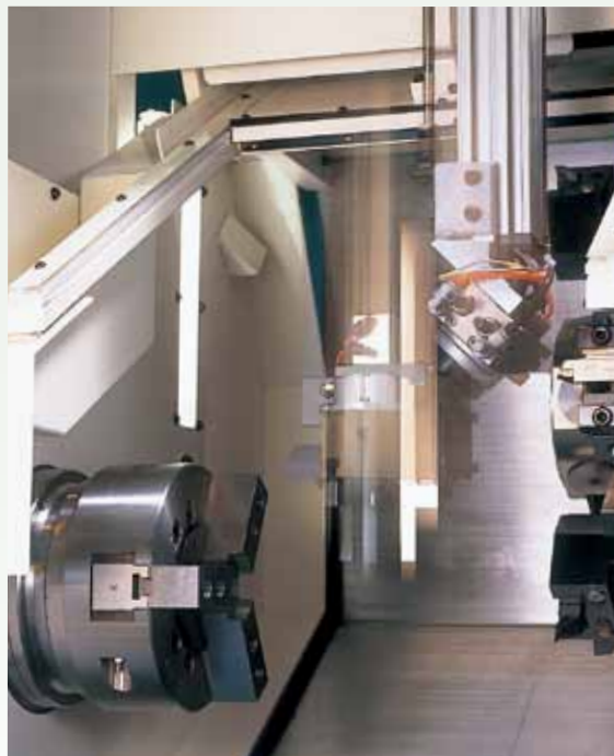
高速サーボローダ High-speed servo load
